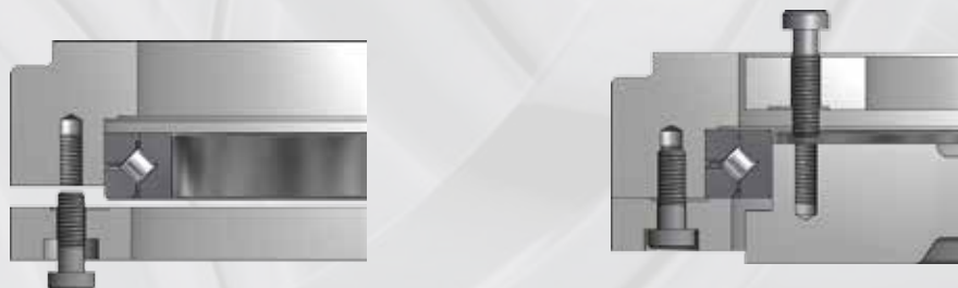
Befestigung von Kreuzrollenlager mit Klemmrings
