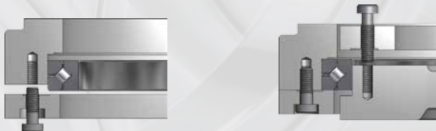
Befestigung von Kreuzrollenlager mit Klemmrings
