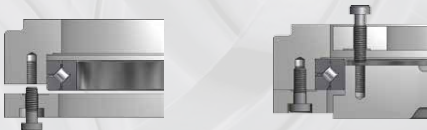
Befestigung von Kreuzrollenlager mit Klemmringsen
